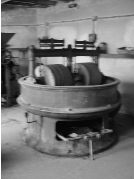
Mélangeur o mezcladora para preparar cobertura de chocolate. Taller de Margarita Sánchez López Acervo fotográfico de Aurelio Sánchez López
